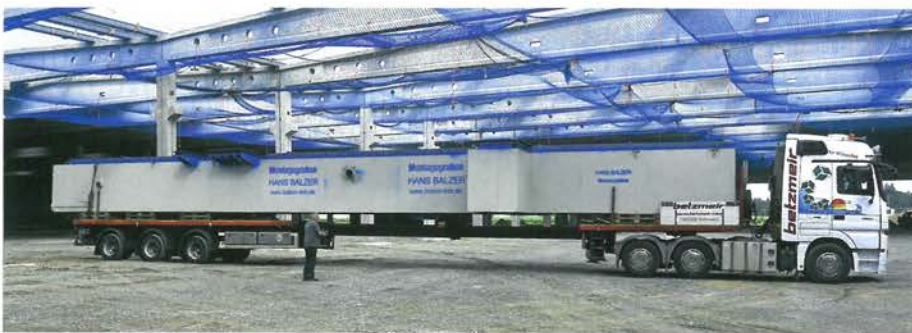
▲ Die 23 Meter lange Fertiggrube ist relativ leicht zu rangieren. Maximal sind 52 Meter Länge möglich.
