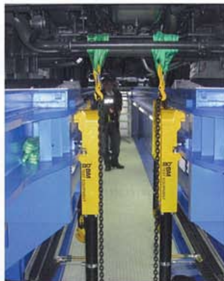
Mit dem ausgeklügelten System können mittels verschiebbarer Zylinder gleichzeitig drei Achslastsimulationen (ALS) vorbereitet werden
