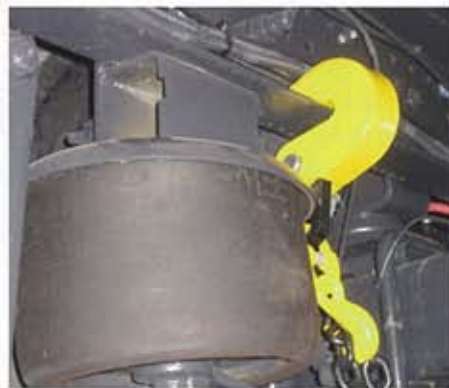
Für die Chassislastsimulation (CLS) werden speziell konstruierte Klauen in das Chassisprofil eingehängt. Die Form der Klaue verhindert ein Verbiegen des Chassisprofils
