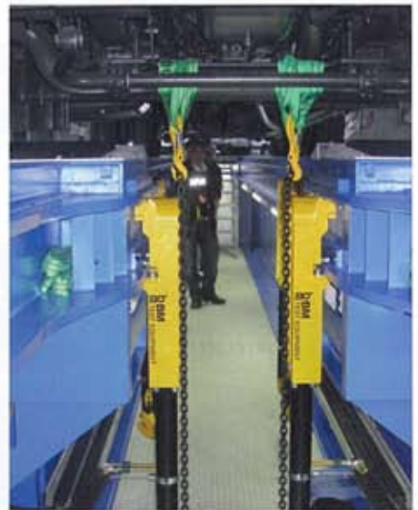
Mit dem ausgeklügelten System können mittels verschiebbarer Zylinder gleichzeitig drei Achslastsimulationen (ALS) vorbereitet werden
