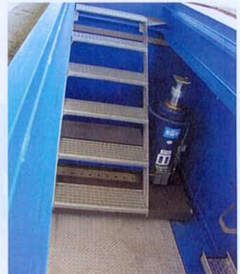
Der Achsabheber in Parkposition unter der Treppe – damit bleibt der Grubeneingang frei.
