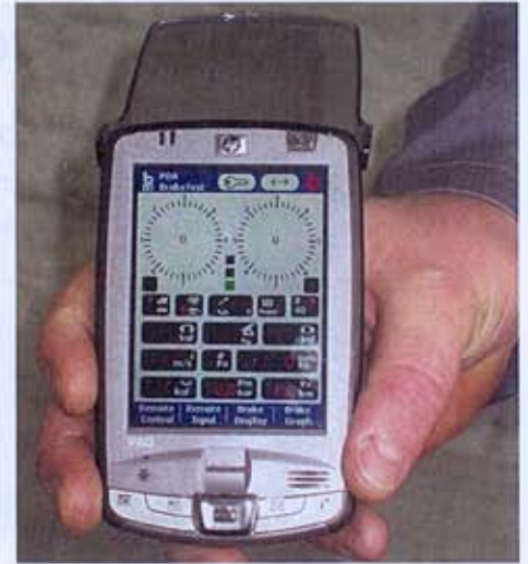
Die Prüfdaten werden auf der Fernbedienung (Funk) angezeigt. Ein direkter Sichtkontakt zum grossen Anzeigendisplay ist nicht nötig.
