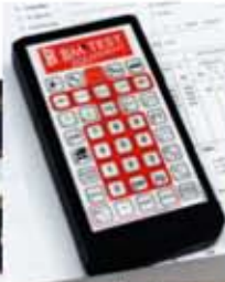
Drahtlos: Über die Fernbedienung wird die Prüfstrasse und der Prüfprozess kabellos gesteuert.
