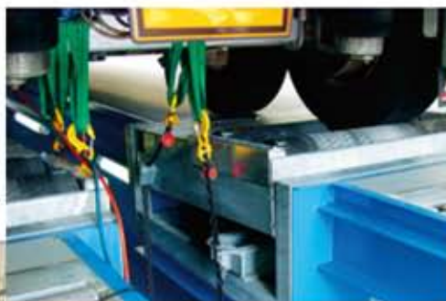
Druck von unten: Die Achslast wird durch das hydraulische Anheben der Rollen simuliert. Eine separate Abspannvorrichtung entfällt.
